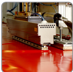
HF Schweißarbeiten high frequency application
