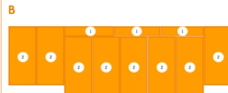
Diese Umklappwände sind 3 m lang und 2,15 m hoch.
